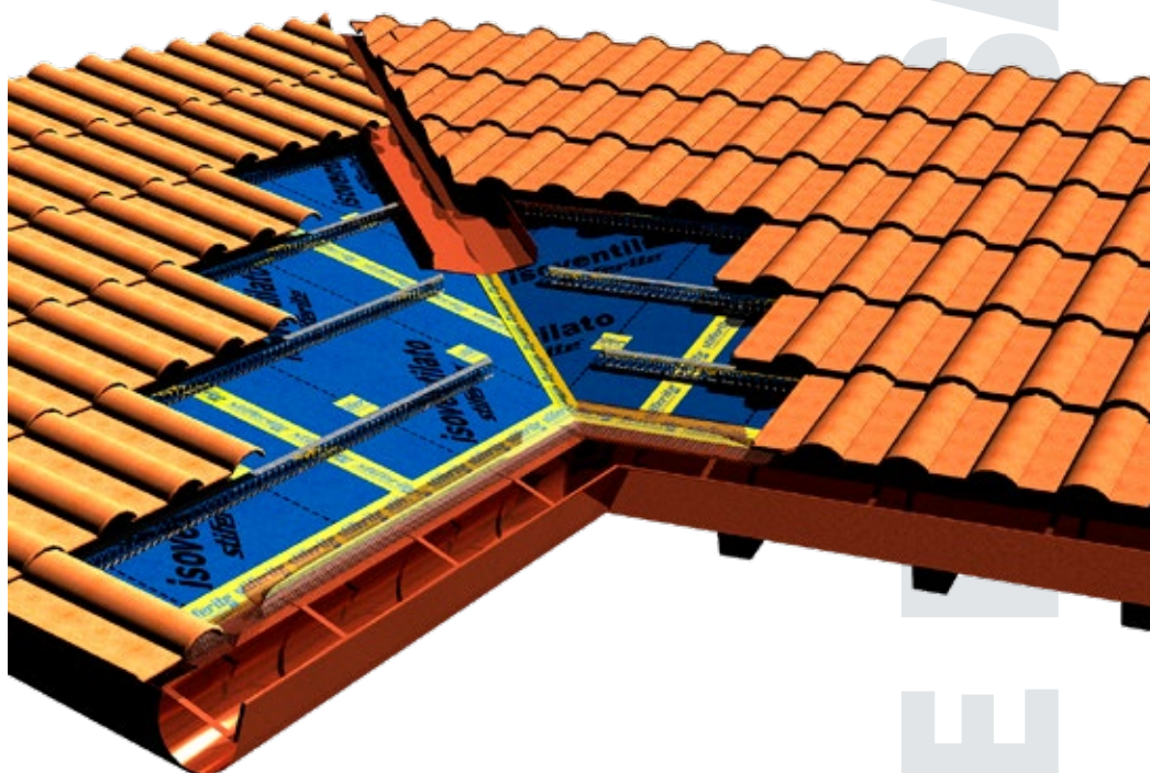
Ancoraggio della lamiera di conversa su listellatura in OBS
